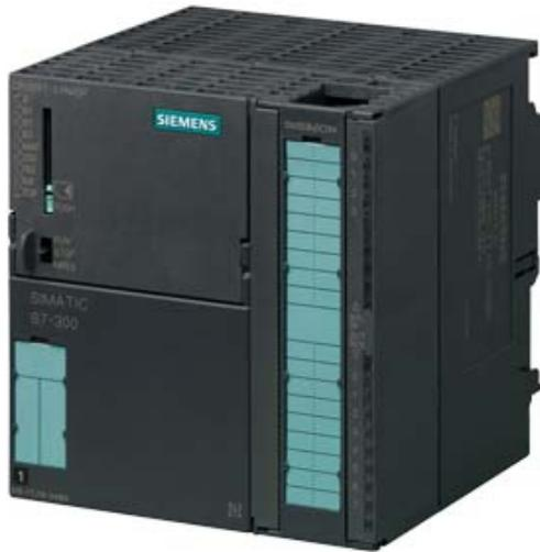
SIMATIC S7-300, CPU 315T-3 PN/DP, ZENTRALBAUGRUPPE FÜR SPS- UND TECHNOLOGIEAUFGABEN, 384 KBYTE ARBEITSSPEICHER, 1. SCHNITTST. MPI/DP 12MBIT/S, 2. SCHNITTST. DP(DRIVE), 3. SCHNITTST. ETHERNET PROFINET MIT 2 PORT SWITCH, INTEGR. I/O FÜR TECHNOLOGIE, FRONTSTECKER (1 X 40POLIG) UND MICRO MEMORY CARD MIN. 8 MB ERFORDERLICH
