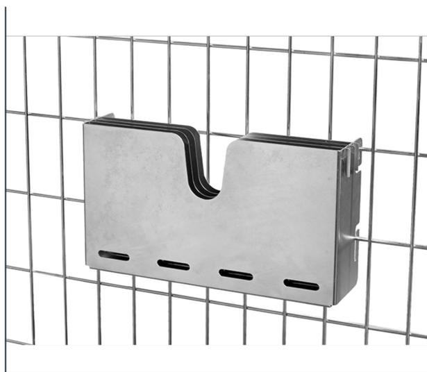
Tôle galvanisée. S'accroche dans le treillis. 3 séparateurs permettent d'avoir 3 logements de disponibles avec ouverture. Dimensions utiles L x H x P : 320 x 170 x 41 mm avec 3 séparateurs : 13 mm de largeur.
