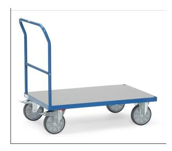
Système modulable. Ensemble mécano-soudé, revêtement époxy bleu RAL 5007. Dimensions utiles 1000 x 700 mm. Plateau en PVC dur gris foncé, résistant aux intempéries et à la plupart des produits corrosifs. 2 roues pivotantes et 2 roues fixes à bandage TPE, moyeu à roulement à billes central. Freins sur roues pivotantes conformément à la Norme 1757-3 (Sécurité des chariots de manutention).
