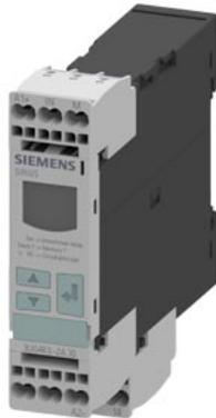
Digitales Überwachungsrelais Spannungsüberwachung, 22.5 mm von 0.1-60 V AC/DC Über- und Unterschreitung AC/DC 24 bis 240 V DC und AC 50 bis 60 Hz Störspitzenverzögerung 0,1 bis 20 s Hysterese 0.1 bis 30 V 1 Wechsler mit oder ohne Fehlerspeicher Federzugtechnik
