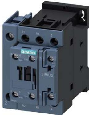
Leistungsschütz, AC-3 25 A, 11 kW / 400 V 2 S + 2 Ö AC 230 V, 50 Hz 4-polig Baugröße S0 Schraubanschluss 1 S + 1 Ö integriert
