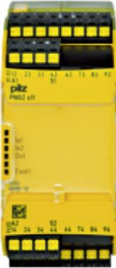
PNOZsigma Kontaktenerweiterung, Ausgänge: 8 S, 1 Ö, UB = 24 V DC, Breite: 45 mm, steckbare Federkraftklemmen, Kontaktblock zur Kontaktenerweiterung in Verbindung mit sicherheitsgerichteten Steuerungsteilen.
