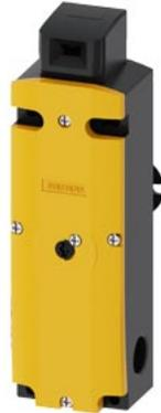
Sicherheits-Positionsschalter mit Zuhaltung Zuhaltkraft 1300 N 5 Anfahrrichtungen Federkraftverriegelt Fluchtentriegelung von hinten und Hilfsentriegelung vorne Magnetspannung AC 230 V Überwachung Betätiger 2Ö/1S Überwachung Magnet 2Ö/1S Lieferung ohne Betätiger. Betätiger 3SE5000-0AV0. bitte separat bestellen
