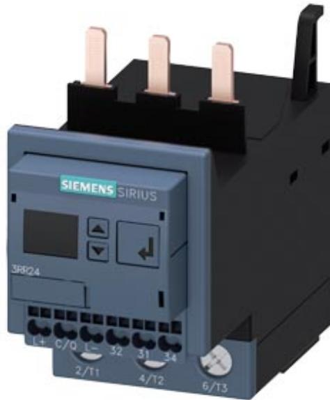
Stromüberwachungsrelais für IO-Link, anbaubar an Schütz, 3RT2, Baugröße S2 Schein-/Wirkstromüberwachung 8-80 A, 20-400 Hz, 3-phasig Versorgungsspannung DC 24 V 1 Wechsler Überwachung auf Stromüber- und Unterschreitung Stromasymetrie Phasenausfall, Drahtbruch Phasenfolge, Fehlerstrom Blockierstrom, Schaltspiel- und Betriebsstundenzähler Warn- und Alarmschwellen AUTO- oder HANDRESET Anlaufverzögerung 0-9999,9 s Ausschaltverzögerung 0-9999,9 s Wiedereinschaltverz. 0-300 min Federzugtechnik
