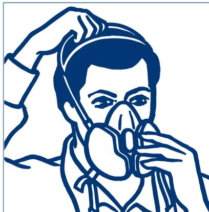
2. Die Maske wird so angelegt, daß sie bequem den Nasenrücken umschließt. Zieht man nun die Kopfbebänderung über den Kopf, so sollte die Maske bereits richtig auf dem Gesicht platziert sein. Falls notwendig, die Maske wieder absetzen und die Kopfbebänderung erneut einstellen und Schritt 2 wiederholen.
