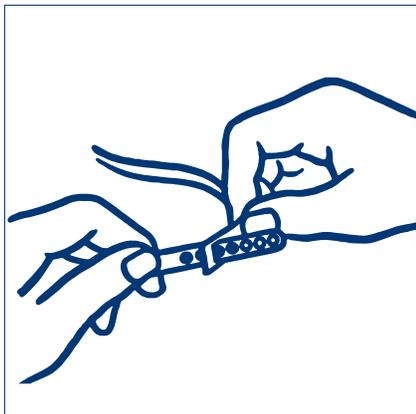
1. Zur Einstellung der Kopfbebänderung wird das Kopfband durch die Lasche geschoben und auf der gewünschten Länge durch Eindrücken des Knopfes fixiert. Der Vorgang ist mit dem zweiten Band zu wiederholen.
