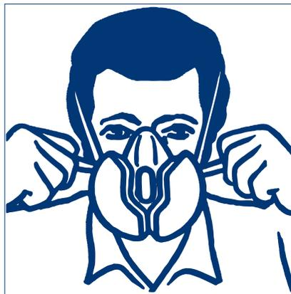
4. Um einen sicheren und festen Sitz der Maske zu erreichen, ziehen Sie zunächst die Enden der Kopfbänder an. Ziehen Sie danach die Nackenbänder in gleicher Weise an. (Die Kopfbebänderung wird gelöst, indem man auf die Schnallenrückseite drückt und das Kopfband aus der Schnalle zieht.)
