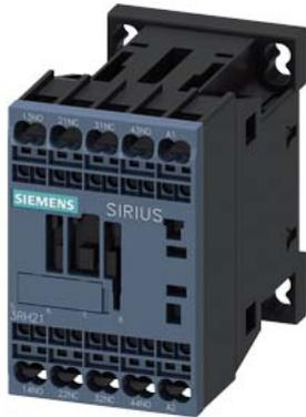
Hilfsschütz, 2 S + 2 Ö, AC 24 V, 50 / 60 Hz, Baugröße S00, Federzuganschluss
