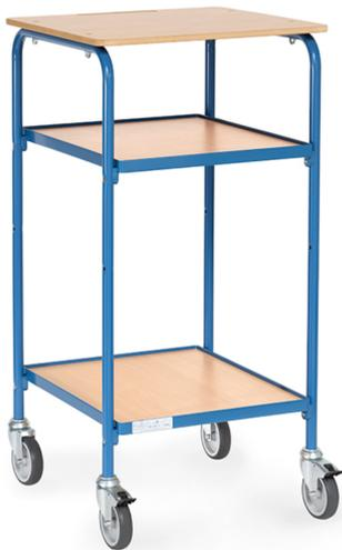
Rollpult aus Stahlrohr und Profilstahl geschweißt, Schraubkonstruktion, pulverbeschichtet, blau RAL 5007. Mit waagerechter Schreibfläche 605 x 591 mm und einer Stiftablege. 2 Ablageböden variabel einschraubbar, 2 Ordnerreihen möglich. Tragkraft pro Boden 50 kg. 4 Lenkrollen mit TPE-Bereifung, Naben mit Gleitlager. 2 Stück mit Feststeller, gemäß der Europäischen Norm EN 1757-3 (Sicherheit von Plattformwagen).
