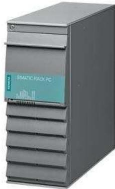
SIMATIC PC Tower-Kit, für Umbau des Rack PC in Industrie Tower PC, für SIMATIC IPC847D, Rack PC 847B, IPC847C
