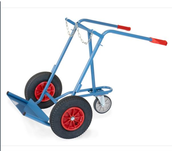
Stahlflaschenkarre aus Stahlrohr geschweißt, pulverbeschichtet blau RAL 5007. Flaschenhalterungen mit Kettensicherung. Räder mit Vollgummibereifung, Naben mit Rollenlager. Schweißdrahtköcher an beiden Holmen. Zusätzlich mit 1 Stütz-Lenkrolle aus Vollgummi 200 x 50 mm.
