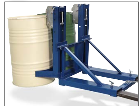
Fassgreifer Typ SH 2 für 2 Fässer à 200 Liter, Traglast: 2x350 kg
