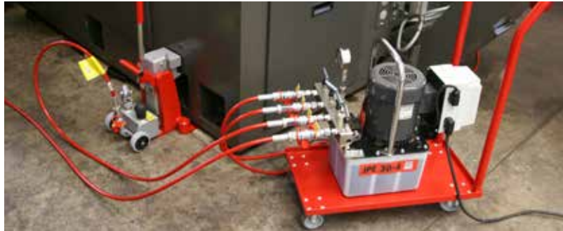
Elektropumpe JPE 30/4 NVR mit 4 Hebegeräten im Einsatz
