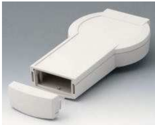
A9079107 DATEC-CONTROL L, Ausf. I ABS (UL 94 HB) grauweiß RAL 9002 266x144x60mm IP 54 opt.
