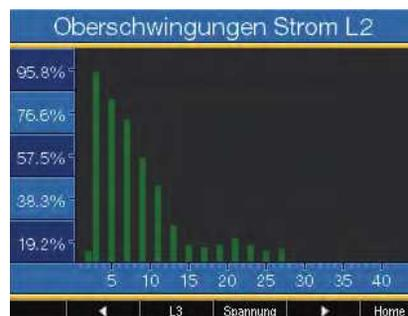
Abb.: Farbiges Grafikdisplay MRG 512 PQ Flex – Beispiel Oberschwingungen
