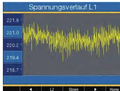
Abb.: Farbiges Grafikdisplay MRG 512 PQ Flex – Beispiel Spannungsverlauf
