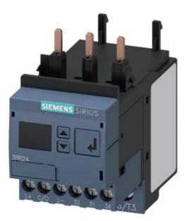
Stromüberwachungsrelais für IO-Link, anbaubar an Schütz 3RT2, Baugröße S0 Schein-/Wirkstromüberwachung 4-40 A, 20-400 Hz, 3-phasig Versorgungsspannung DC 24 V 1 Wechsler Überwachung auf Stromüber- und Unterschreitung Stromasymetrie Phasenausfall, Drahtbruch Phasenfolge, Fehlerstrom Blockierstrom, Schaltspiel- und Betriebsstundenzähler Warn- und Alarmschwellen AUTO- oder HANDRESET Anlaufverzögerung 0-9999,9 s Ausschaltverzögerung 0-9999,9 s Wiedereinschaltverz. 0-300 min Schraubanschlusstechnik
