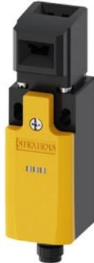
Sicherheits-Positionsschalter mit getrenntem Betätiger Kunststoffgehäuse, 31 mm nach DIN EN 50047 1S/1Ö Schleikontakte mit M12-Stecker, 5-polig, fest und 2 LEDs gelb/grün DC 24 V, 5 Anfahrrichtungen Pin-Belegung: Pin1=21, Pin2=22 PIN3=14 und LED grün, Pin4=13 und LED gelb, Pin5=Masse LED der dazu passende getrennte Betätiger 3SE5000-0AV0. muss separat bestellt werden
