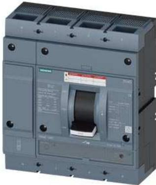
Leistungsschalter 3VA5 UL Frame 800 Schaltvermögenklasse M 35kA @ 480 V 4-polig, Anlagenschutz TM230, FTAM, In=800A Überlastschutz Ir=800A fest eingestellt Kurzschlusschutz Ii=5...10 x In N-Leiter 1 Schraubenflächanschluss
