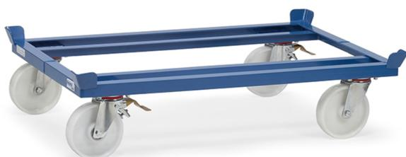
Construction robuste en profilé d'acier avec 4 coins de centrage, revêtement époxy bleu RAL 5007, 2 roues pivotantes en polyamide, moyeu à roulement à billes de précision, 2 roues pivotantes à freins placées sous le châssis et diagonalement. Garde au sol : 235mm
