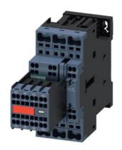
Leistungsschütz, AC-3e/AC-3, 25 A, 11 kW / 400 V, 3-polig, AC 230 V, 50/60 Hz, mit eingestecktem Varistor, Hilfskontakte: 2 S + 2 Ö, Federzuganschluss, Baugröße: S0, Hilfsschalter unlösbar
