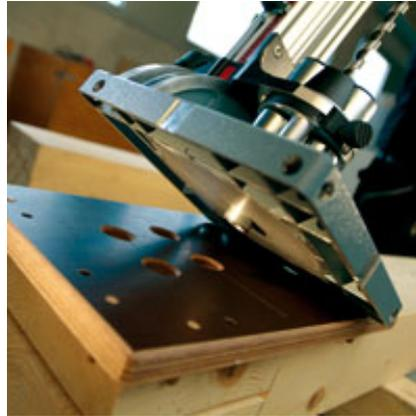
Für Serienbohrungen und Lochbilder kann die Einlegeplatte getauscht werden. Ideal für das Arbeiten mit Bohrschablonen.
