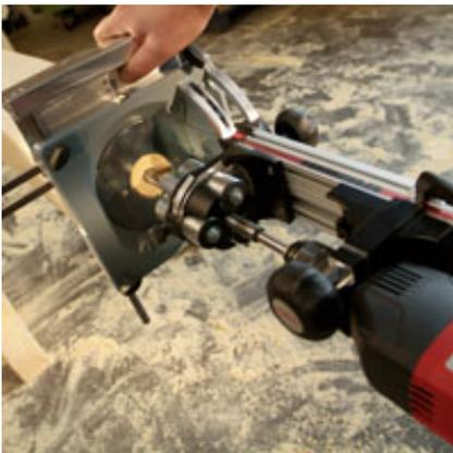
Der Parallelanschlag z.B. für Stirnholzbohrungen, ergibt in Kombination mit dem Seitenanschlag das ideale Paar für Serienfertigungen.
