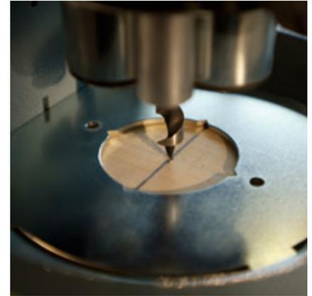
Mit den Anrisskerben kann der Bohrer äußerst präzise angesetzt werden.
