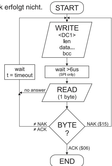
Eingerahmt von <DC1>, der Anzahl der Daten "len" und der Prüfsumme "bcc" werden die jeweiligen Nutzdaten übertragen. Als Antwort sendet das Display <ACK> zurück.
