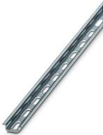
Tragschiene gelocht, nach EN 60715, Material: Stahl, verzinkt, weiß-passiviert, Standardprofil, Farbe: silberfarben, Verpackungsvariante mit 10 Stück (20 m)
