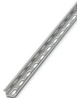
Tragschiene gelocht, nach EN 60715, Material: Aluminium, unbeschichtet, Standardprofil, Farbe: silberfarben, Verpackungsvariante mit 10 Stück (20 m)
