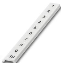
Zackband flach, Streifen, weiß, beschriftet, quer bedruckt: fortlaufende Zahlen 1 .. 10, 11 ... 20 usw. bis 91 ... 100, Montageart: verrasten, für Klemmenbreite: 6,2 mm, Schriftfeldgröße: 5,15 x 6,15 mm, Anzahl der Einzelschilder: 10
