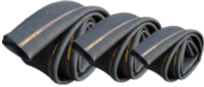
Zementsiloschlauch, besonders für Betontrichter. Geeignet zum Durchleiten von Zement, Beton, Sand und Kies, hochabriebfeste, elektroleitfähige Mischung, Decke witterungsbeständig.
