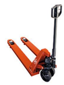
Rollen: - Tandemrolle: bei unebenem Boden, bei Schwellen, niedrigerer Verschlei ss 10 bzw. 12 Schmiernippel für eine hohe Lebensdauer Nennkraft: 2300 kg Reduzierte Nenntragfähigkeit: 2000 kg Hubhöhe: 200 mm Ma ss über die Gabel: 520 mm Gabelbreite: 156 mm Gabellänge 2000 mm Gabelhöhe im gesenkten Zustand: 85 mm Lenkrollendurchmesser: 175 mm Lenkrollenbreite: 60 mm Gewicht: ca. 65 kg Garantie: 5 Jahre (ausgenommen Verschlei ssteile) Farbe: Rot
