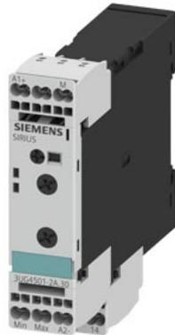
Analoges Überwachungsrelais Füllstandsüberwachung Widerstandsüberwachung von 2 bis 200 kOhm Über- und Unterschreitung AC/DC 24 bis 240 V DC und AC 50 bis 60Hz 2 Punkt-oder 1 Punkt-Regelung Auslöseverzögerung 0,5 bis 10 s 1 Wechsler Federzugtechnik
