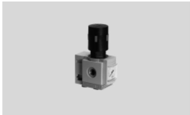
Das Druckregelventil ist geeignet für Batteriemontage mit durchgeführter Versorgungsluft, zum Aufbau einer Reglerbatterie mit voneinander unabhängigen Druckregelbereichen. Der Druckausgang ist vorn oder hinten.
