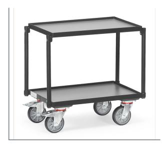
Etagen-Roller mit 2 Plattformen. Beide Rahmen mit Böden aus Holzwerkstoffplatte, Oberfläche mittelgrau, Rand 15 mm hoch. Pulverbeschichtet anthrazitgrau RAL 7016. Lichter Etagenabstand 400 mm. Tragkraft obere Ladefläche 100 kg. 4 Lenkrollen mit TPE-Bereifung, Naben mit Rillenkugellager. 2 Stück mit Feststeller, gemäß der Europäischen Norm EN 1757-3 (Sicherheit von Plattformwagen). Passend für Eurokästen 600 x 400 mm. Zerlegte Anlieferung.
