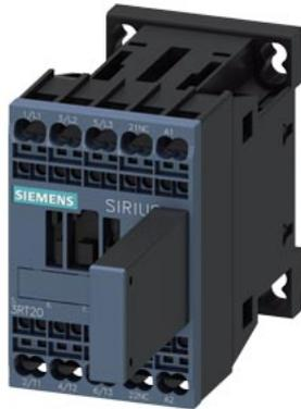
Leistungsschütz, AC-3e/AC-3, 12 A, 5,5 kW / 400 V, 3-polig, AC 230 V, 50/60 Hz, mit aufgestecktem RC-Glied, Hilfskontakte: 1 Ö, Federzuganschluss, Baugröße: S00
