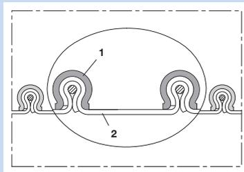
Tuyau à profilé de serrage (tuyau clippé), tuyau alimentaire et pharmaceutique, haute résistance chimique (jusqu'à +270°C)
