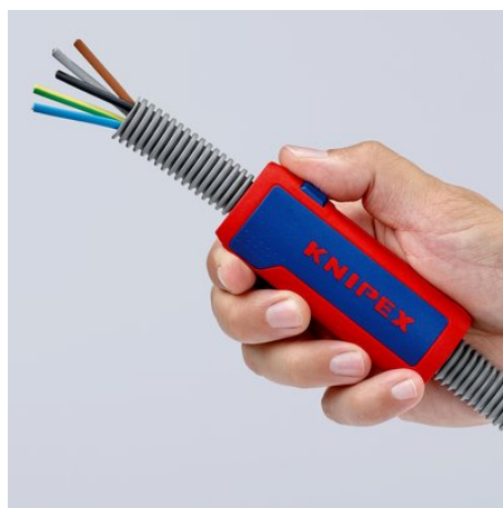
Bordo di taglio pulito e nessun danno ai cavi posti all'interno, grazie al taglio eseguito sempre sopra l'ondulazione | Einfache Handhabung: KNIPEX TwistCut® zusammendrücken, mit leichtem Druck drehen, fertig!
