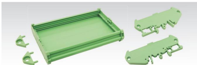
Kunststoffhalterung zur einfachen Montage des Motorcontrollers SFRG 3, zur Befestigung auf Tragschienen nach EN 60715 mit Weite 35mm oder an einer Gehäuserückwand. Bauhöhe SFRG 3 im Geräteträger auf einer Tragschiene 7,5 mm: 76 mm. Auf einer Gehäuserückwand: 60 mm. **Dieser Geräteträger ist im Lieferumfang des Motorcontrollers SFRG 3 enthalten.**
