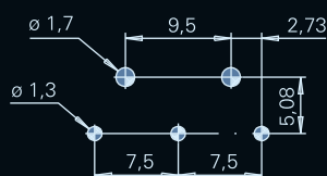
Bohrbild für LP-Anschluss 0,6 x 0,5 mm seitlich mit Fixierzapfen
