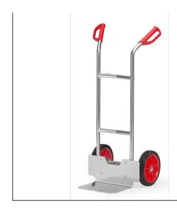
Ensemble mécano-soudé en aluminium. Soigneusement soudé sans revêtement, léger et maniable. Poignées de sécurité en plastique dur. Tablier cintré permettant d'embarquer des éléments ronds tels que rouleaux, bidons, seaux etc. Bavette en tôle d'alu à boulonner et remplaçable. Roues à bandage caoutchouc, moyeu à roulement à rouleaux. Livrée avec bavette démontée.
