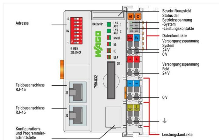
Der BACnet/IP-Controller 750-832 verbindet das WAGO-I/O-SYSTEM mit dem Protokoll BACnet/IP. Der 750-832 entspricht dem BACnet-Device-Profil B-BC gemäß DIN EN ISO 16484-5. Die Kommunikation mit anderen BACnet-Geräten erfolgt über BACnet/IP.
