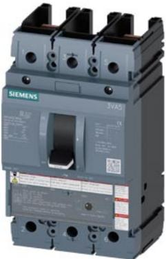
Leistungsschalter 3VA5 UL Frame 250 Schaltvermögenklasse H 65kA @ 480V 2-polig, Anlagenschutz TM210, FTFM, In=200A Überlastschutz I<sub>r</sub>=200A fest eingestellt Kurzschlusschutz I<sub>i</sub>=10 x In ohne Anschluss
