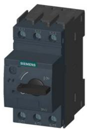
LEISTUNGSSCHALTER BGR. S00, FUER DEN MOTORSCHUTZ, CLASS 10, A-AUSL.0,9...1,25A, N-AUSL.16A, SCHRAUBANSCHLUSS, STANDARDSCHALTVERMOEGEN
