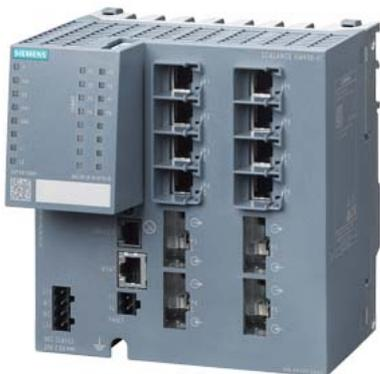
SCALANCE XM408-4C; managed modular IE Switch; 8x 10/100/1000 Mbit/s RJ45; 4x 100/1000 Mbit/s ST-/SC- Pluggable als Combo-Ports; in Summe 8 Ports nutzbar; erweiterbar auf 24 Ports elektrisch oder optisch; Montage: Hut-/S7-Profileschiene, PROFINET IO Device; Redundanzfunktionen; Office Features (RSTP, VLAN, IGMP,..); C-PLUG im Lieferumfang; Layer 3 integriert.
