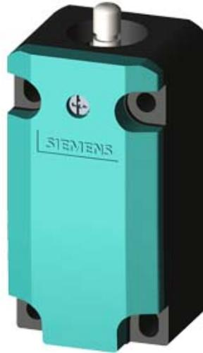
SIRIUS POSITIONSSCHALTER, BASISCHALTER, KUNSTSTOFF, 40MM, NACH EN50041 ERHOEHTER KORROSIONSSCHUTZ, GERAETEANSCHLUSS 1X (M20X1,5) 1S/ 2OE SPRUNGKONTAKTE FUNKTIONSFAEHIG BEI -40 GRAD, SCHOCK-UND SCHWINGPRUEFUNG NACH EN61373, KATEGORIE 1B
