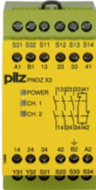
Sicherheitsschaltgerät (standalone), Eingänge: 1/2-kanalige Beschaltung mit/ohne Querschlusserkennung, Ausgänge: 3 S, 1 Ö, 1 HL, automatischer/überwachter Start, UB = 24 V AC/DC, Breite: 45 mm, Schraubklemmen integriert, Überwachung von Not-Halt, Schutztüren.
