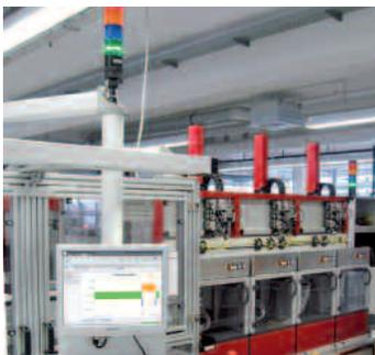
Die Software stellt die Zustände der ins Funknetzwerk eingebundenen Signalsäulen dar
