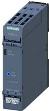
Thermistor-Motorschutzrelais Standard-Auswertegerät 22,5 mm Gehäuse Federzugklemme 2 Wechsler US = AC/DC 24 V-240 V Hand/Fern-RESET mit ATEX-Zulassung 2 LEDs (READY/TRIPPED) galvanische Trennung Test-/RESET-Taste Drahtbruchüberwachung Kurzschlussüberwachung
