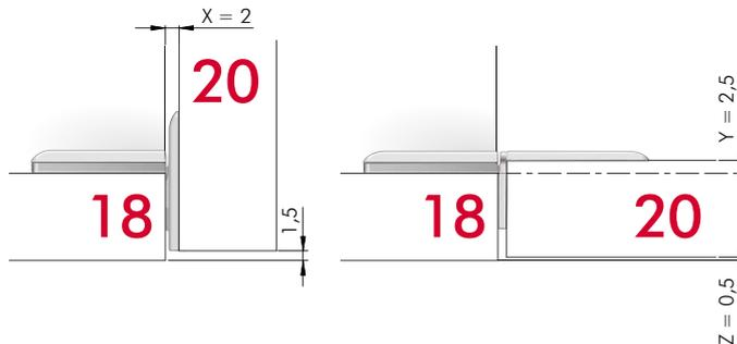
**KORPUSPLATTENSTÄRKE 18 mm OHNE ADAPTERPLATTE - TÜRSTÄRKE 20 mm OHNE ADAPTERPLATTE**
