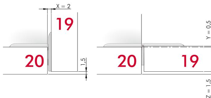
**KORPUSPLATTENSTÄRKE 20 mm OHNE ADAPTERPLATTE - TÜRSTÄRKE 20 mm OHNE ADAPTERPLATTE**
