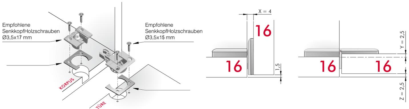
**KORPUSPLATTENSTÄRKE 16 mm MIT ADAPTERPLATTE 4 mm - TÜRSTÄRKE 19 mm OHNE ADAPTERPLATTE**
