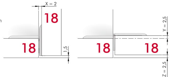
**KORPUSPLATTENSTÄRKE 18 mm MIT ADAPTERPLATTE 2 mm - TÜRSTÄRKE 19 mm OHNE ADAPTERPLATTE**
