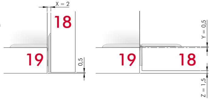
**KORPUSPLATTENSTÄRKE 19 mm OHNE ADAPTERPLATTE - TÜRSTÄRKE 19 mm OHNE ADAPTERPLATTE**
