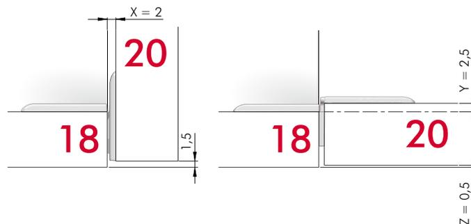
**KORPUSPLATTENSTÄRKE 19 mm OHNE ADAPTERPLATTE - TÜRSTÄRKE 16 mm MIT ADAPTERPLATTE 2 mm**
