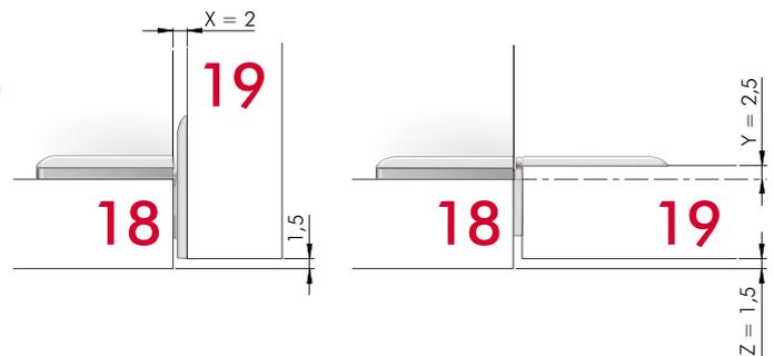
**KORPUSPLATTENSTÄRKE 18 mm OHNE ADAPTERPLATTE - TÜRSTÄRKE 19 mm OHNE ADAPTERPLATTE**
