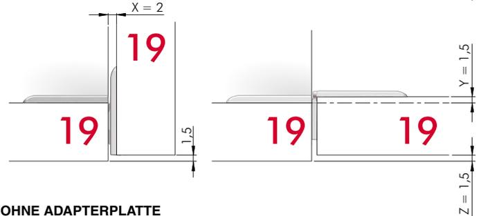
**KORPUSPLATTENSTÄRKE 19 mm OHNE ADAPTERPLATTE - TÜRSTÄRKE 20 mm OHNE ADAPTERPLATTE**
