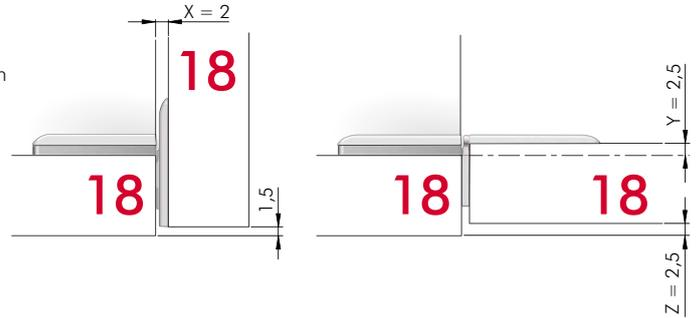
**KORPUSPLATTENSTÄRKE 18 mm OHNE ADAPTERPLATTE - TÜRSTÄRKE 18 mm OHNE ADAPTERPLATTE**
