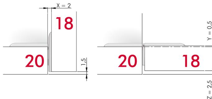
**KORPUSPLATTENSTÄRKE 20 mm OHNE ADAPTERPLATTE - TÜRSTÄRKE 19 mm OHNE ADAPTERPLATTE**
