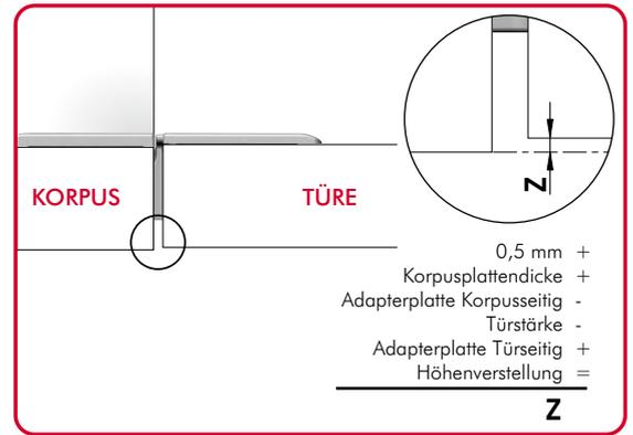
**KORPUSPLATTENSTÄRKE 16 mm MIT ADAPTERPLATTE 4 mm - TÜRSTÄRKE 16 mm MIT ADAPTERPLATTE 2 mm**
