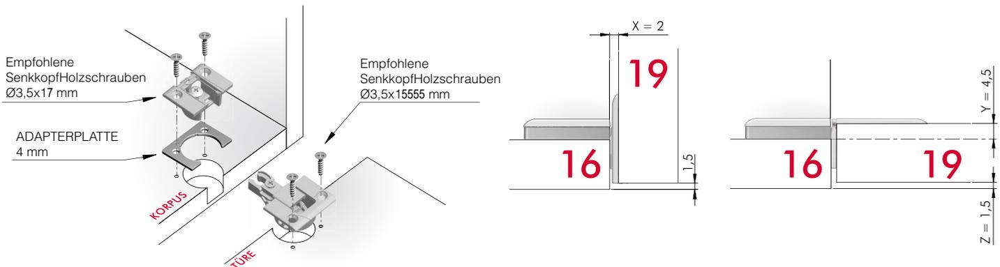
**KORPUSPLATTENSTÄRKE 16 mm MIT ADAPTERPLATTE 4 mm - TÜRSTÄRKE 20 mm OHNE ADAPTERPLATTE**
