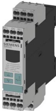
Digitales Überwachungsrelais Drehzahlüberwachung von 0.1 bis 2200 U/min Über- und Unterschreitung Versorgungsspannung: AC/DC 24 V DC und AC 50 bis 60 Hz ohne galvanische Trennung zum Messkreis Anlaufverzögerung 1 bis 900 s Auslöseverzögerung 0,1 bis 99,9 s Hysterese 0.1 bis 99 U/min 1 Wechsler mit oder ohne Fehlerspeicher Federzugtechnik
