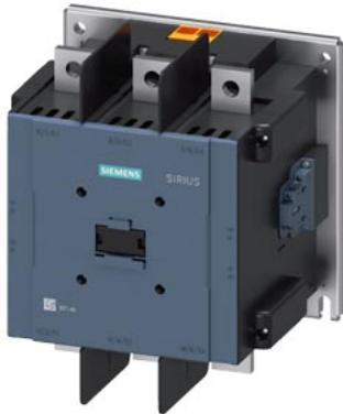
Leistungsschütz AC-1 1050A / 690 V / 40°C 3-polig, U<sub>c</sub>: 220-240 V AC(50-60 Hz) / DC Antrieb: konventionell Hilfskontakte 2 S + 2 Ö Hauptstr.: Schiene Steuer- und Hilfsstromkreis: Schraubanschluss
