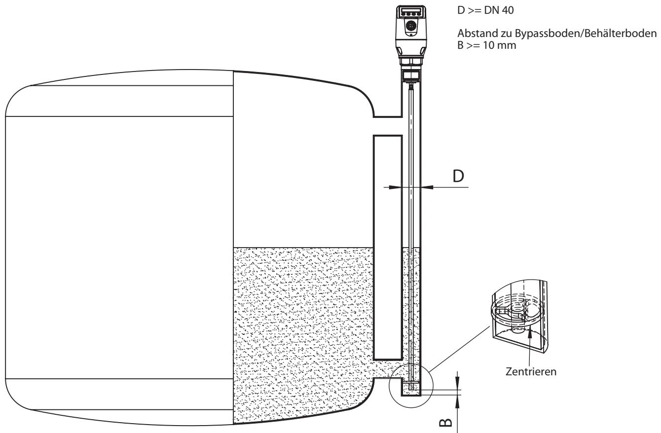
Einbau in einen metallischen Behälter
