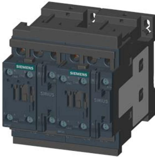
WENDEKOMB. FUER 3RA27, AC3, 11KW/400V, DC 24V 3POL, BGR. S0 SCHRAUBANSCHLUSS ELEKTR. UND MECH. VERRIEGELUNG 2S INTEGR.
