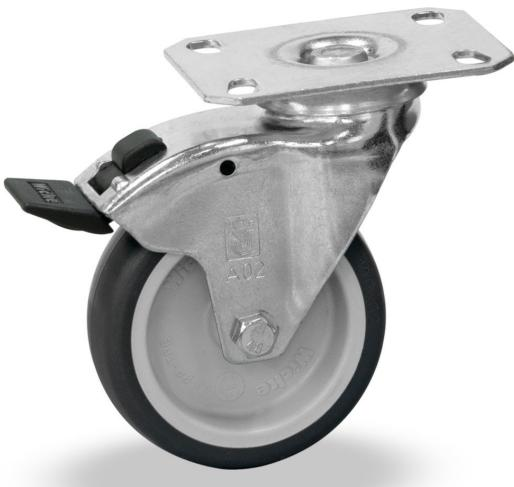
Armature en tôle d'acier galvanisée. Roue à bandage TPE (Élastomère thermoplastique), moyeu à palier lisse. Déplacement silencieux sur sols plats, peu de résistance au déplacement et à la rotation. Bandage non traçant.
